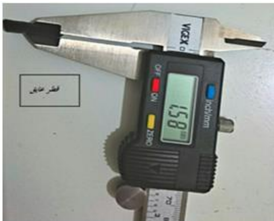
شکل ۹: اندازه‌گیری قطر عایق کابل خودنگهدار
