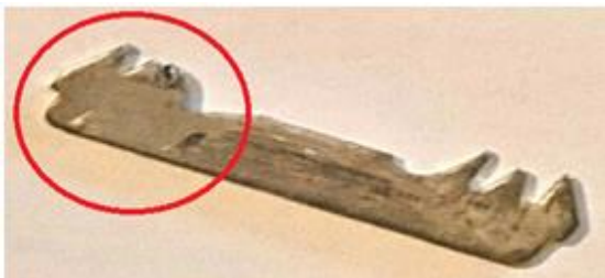
شکل ۲: تصویر له‌شدگی در تیغه کلمپ انشعابی
