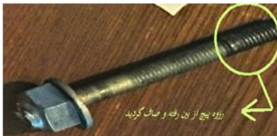
شکل ۳: عدم رعایت استاندارد در ساخت پیچ کلمپ انشعابی
